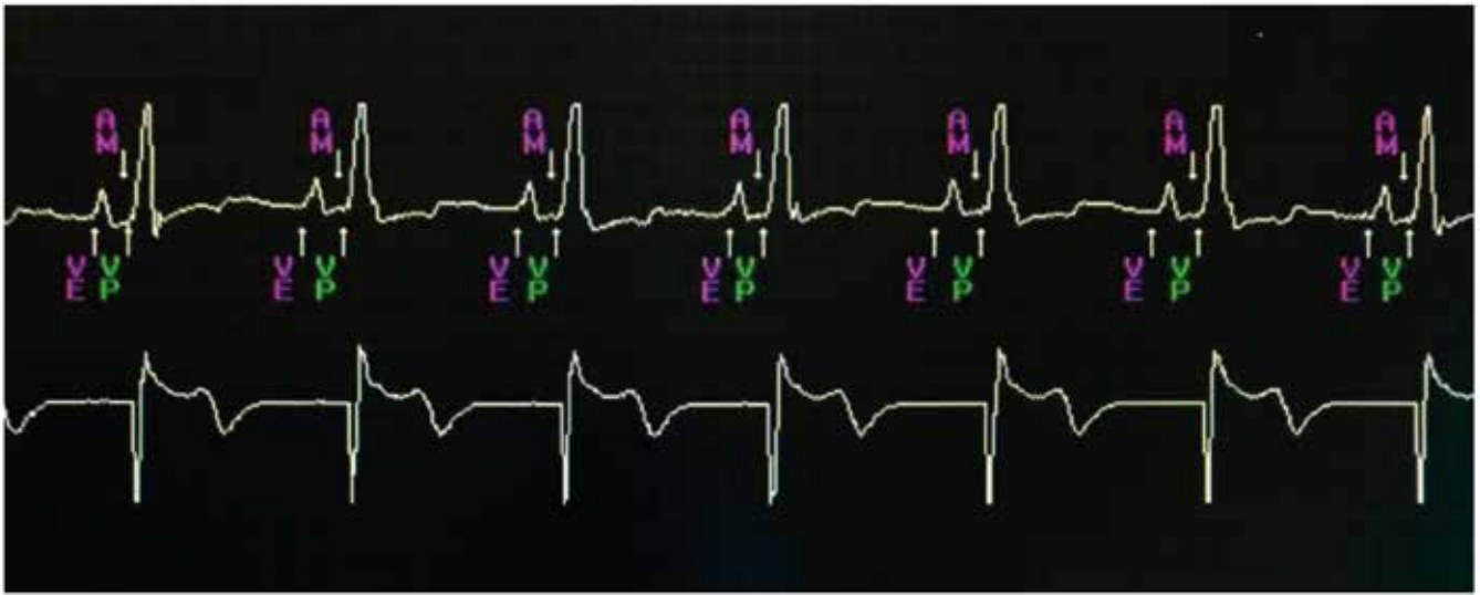
KUVA 4. Näkymä Micra AV -tahdistimesta ohjelmointilaitteella. Ylemmällä rivillä on EKG ja siihen yhdistettynä tahdistimen annotaatiot. Laite tunnistaa vaiheen, jossa kammion passiivinen täyttö päättyy (VE = ventricular end ), sekä eteisen mekaanisen supistuksen diastolen lopussa pian P-aallon jälkeen (AM = atrial mechanical ). Eteistunnistusta seuraa kammiotahdistus (VP = ventricular pace ). Alemmalla rivillä on EGM-käyrä. Eteisen tunnistus ei näy EGM:ssä, koska laite ei tunnista eteistä sähköisesti vaan pelkästään mekaanisesti.
